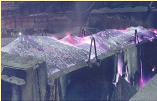
Tradisjonell åpen ovn for produksjon av silisiumkarbid.
