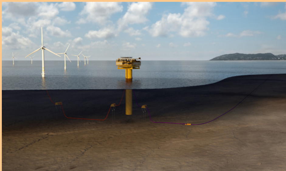
Deep Purple system for offshore produksjon av hydrogen med transport av hydrogen til land. Illustrasjon: TechnipFMC
