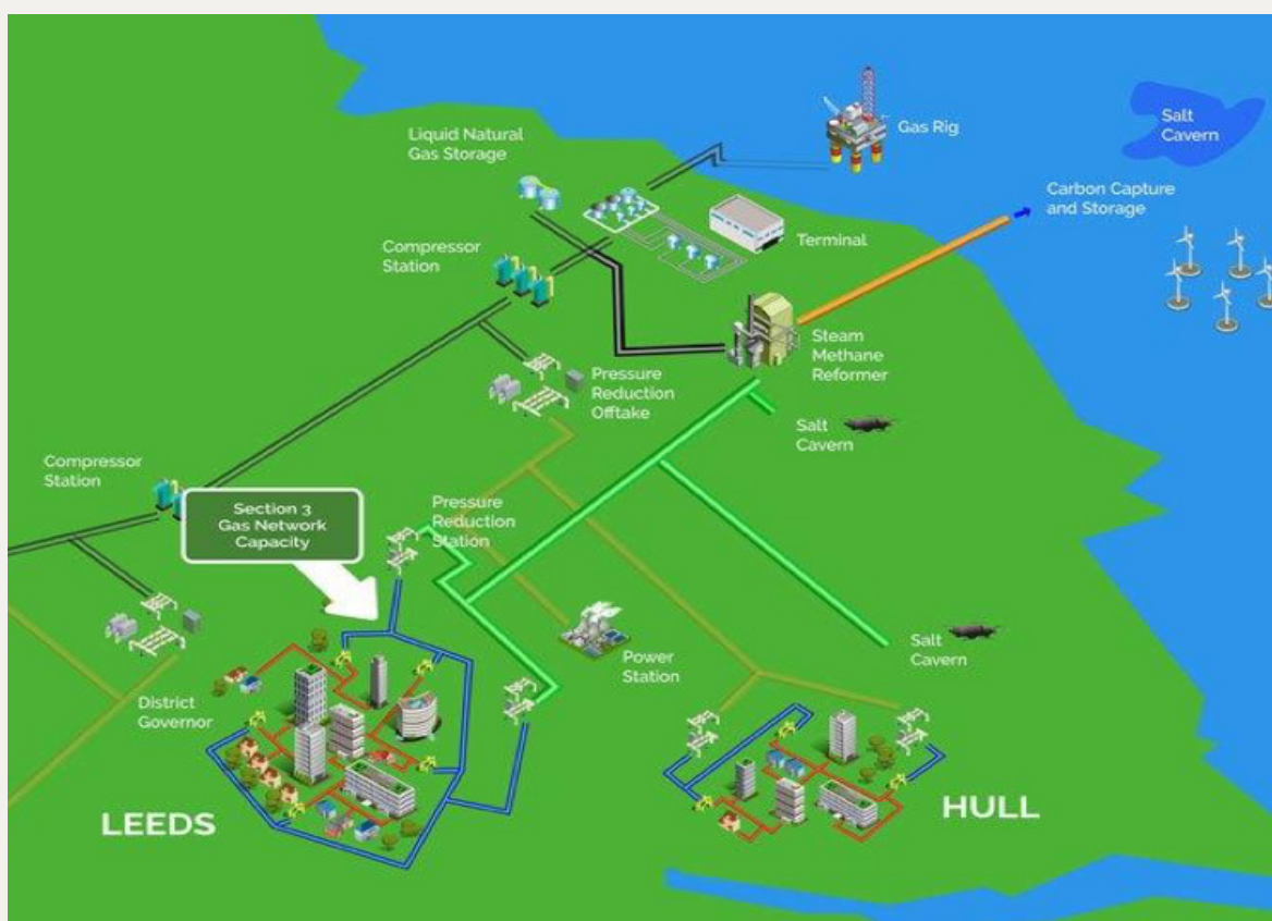
Konsept for fullskala verdikjede for hydrogen fra naturgass med CO 2 fangst og lagring
