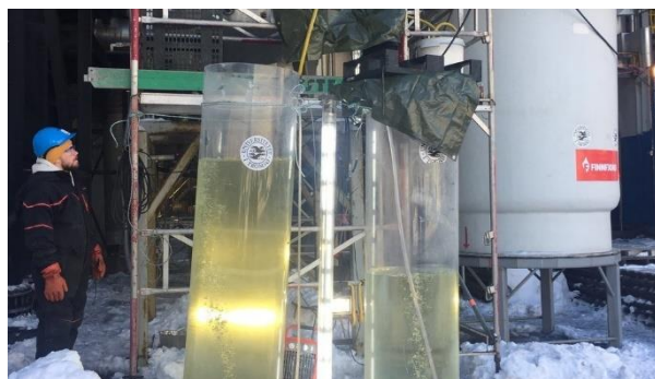
Figur 25. Dyrking av kiselalger i vann med røyk fra smelteanlegget i Finnfjord, Troms. Hentet fra [96].
