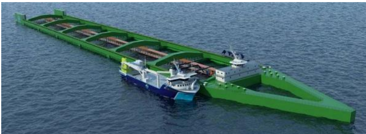
Figur 45 Det nye skipsformede havbrukskonseptet til Nordlaks. Illustrasjon: NSK Ship Design.
