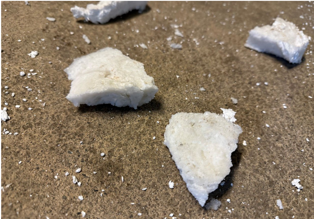
Bildet viser deler av komprimert EPS med avvik som har gjort materialet hardt som stein. Avviket er trolig EPE eller EPP, som har et lavere smeltepunkt enn EPS.
