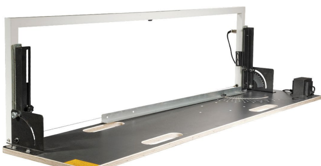
Varmekniv med bord for platekapping
