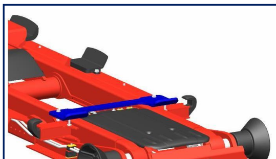
Figur 3: Eksempel på bakre mekanisk lås (1)
